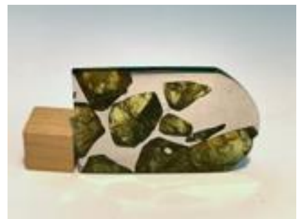
(写真-2：パラサイト隕鉄の研磨された切片、 白色の地がFe-Ni合金、緑色の粒がオリビン)
